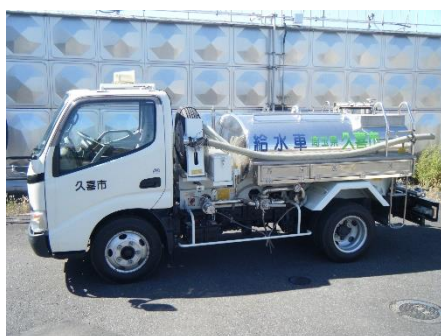
給水車（加圧式）
