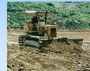
機械寸法：3.4×2.2×2.5(m) (3tブルドーザ)
