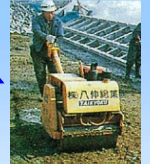
機械寸法：2.3×0.6×1.1(m) (振動ローラ ハンドガイド式)
