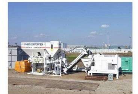
コンパクト施工システムのプラント設備
