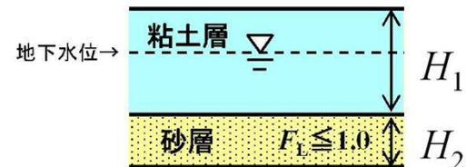
(b) 砂層の上に粘土層がある場合 (地下水位が粘土層内)
