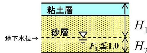
(c) 砂層の上に粘土層がある場合 (地下水位が砂層内)
