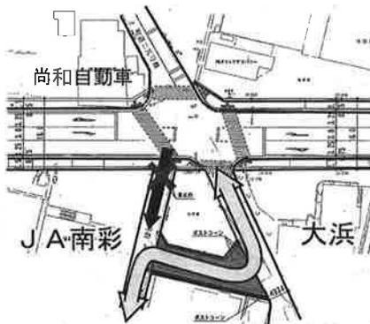
県道川越栗橋線の新堀五差路の交差点改良工事です。一方通行（青矢印）を止め、新たな接続道（赤塗り）をつくる
