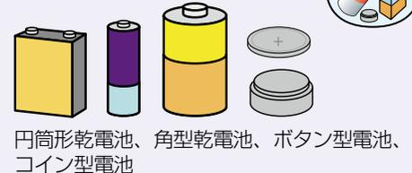
円筒形乾電池、角型乾電池、ボタン型電池、
