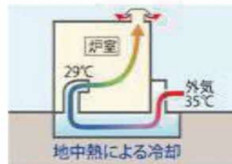
地中熱換気システム
